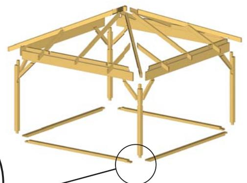
Abb. Konstruktion mit Fundamentrahmen
