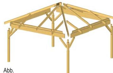
Abb. Konstruktion ohne Fundamentrahmen
